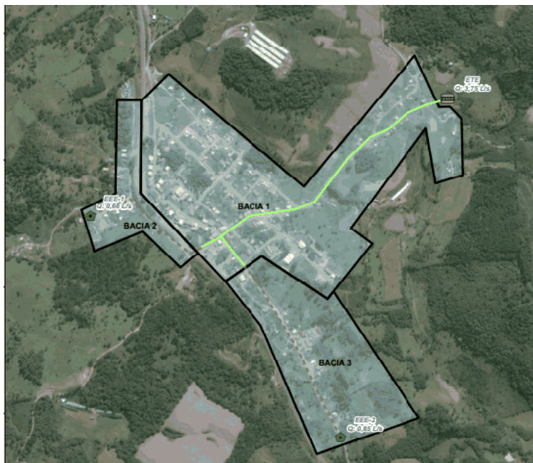
Figura 43 - Disposição das microbacias de captação de efluentes, e localização das Estações Elevatórias e da Unidade de Tratamento de Efluentes
